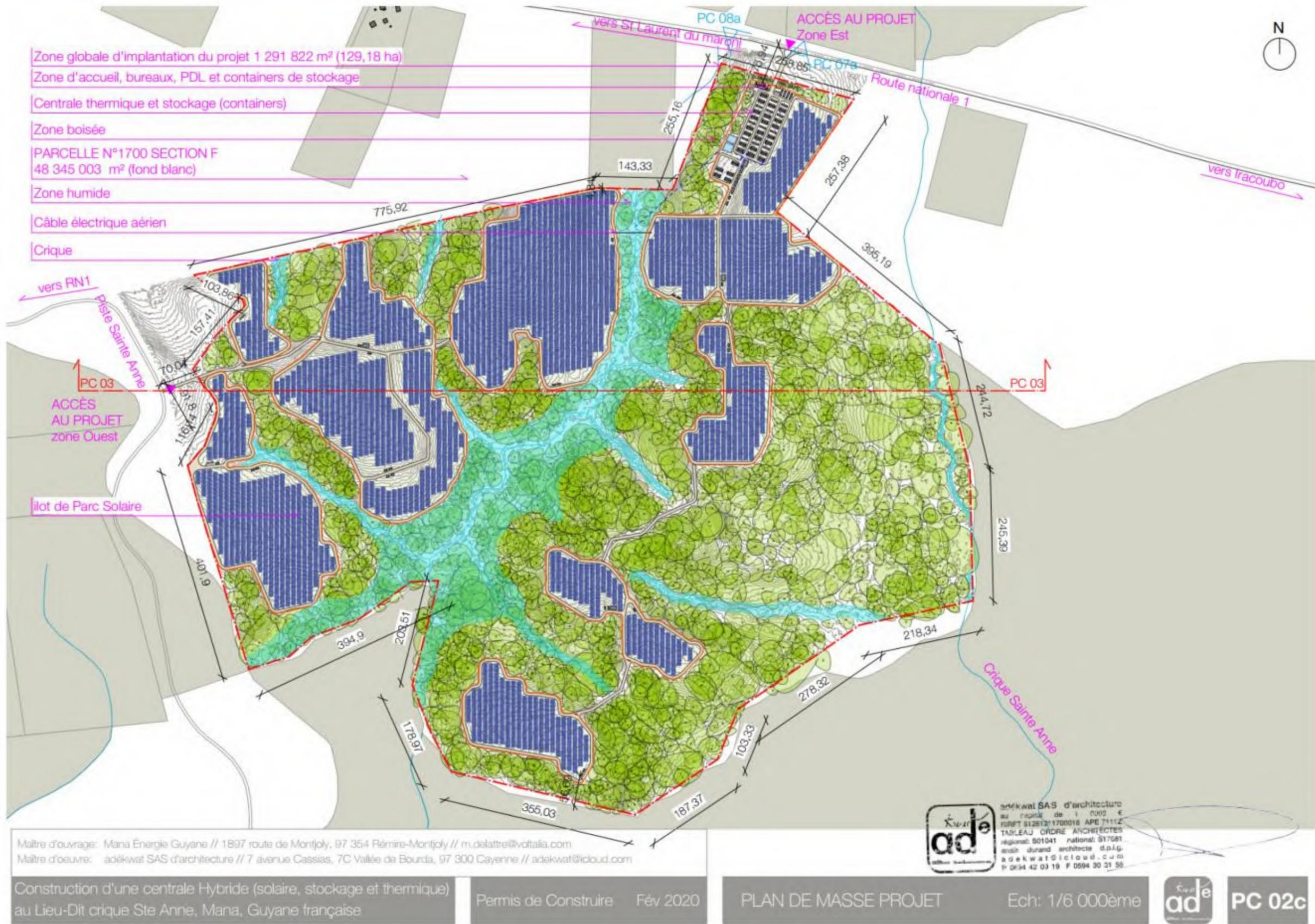
Figure 87 : Plan de masse de la centrale électrique hybride (extrait du PC)
